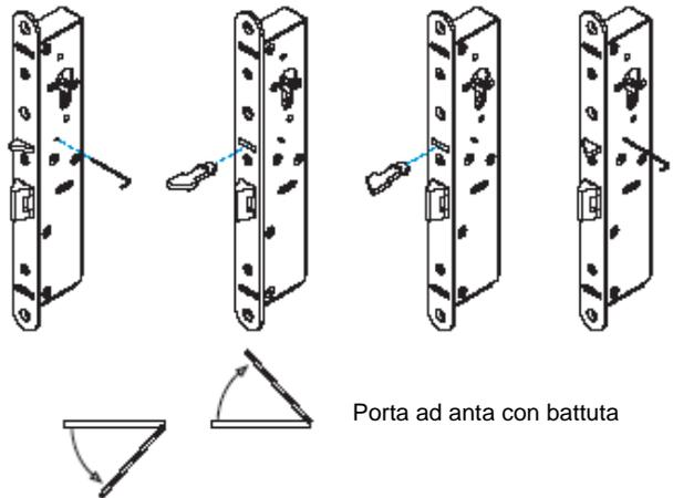
Nella serratura può essere sostituito il sistema di blocco scrocco da porta ad anta con battuta a porta a vento
